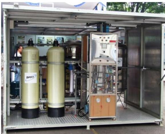
Gambar 17. Unit Pengolah Air Sistem Reverse Osmosis Stasioner Untuk Mengolah Air Asin Kapasitas 10 m<sup>3</sup>/hari.
